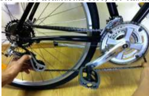
Рис. Проверка свободного хода цепи: 1 этап – зажать отрезок цепи; 2 этап – изогнуть отрезок поперек.
